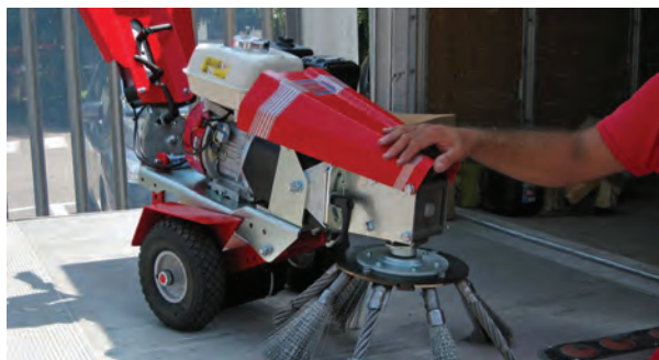
▲ Maquinaria de cepillos de acero autopropulsados.
