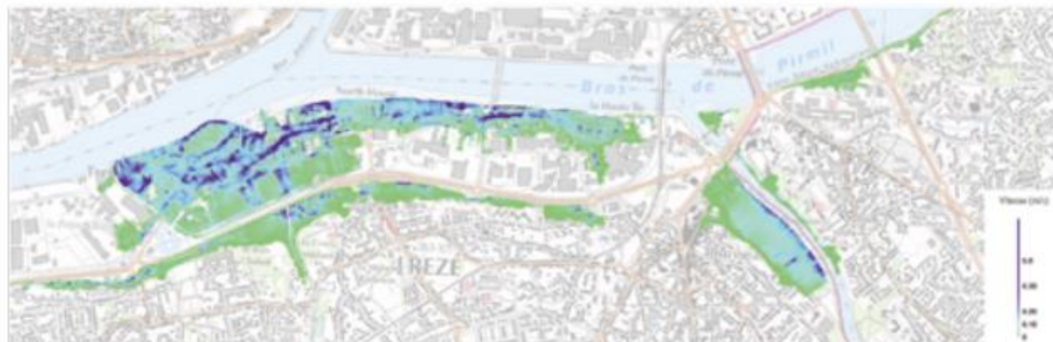
Fig. 18 - Vérification de l'impact de la création d'un chemin hors d'eau en remblai sur les vitesses d'écoulement de l'eau par rapport à la situation actuelle
